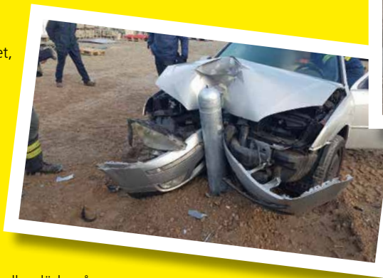
Foto från HITSAs test av fartreducerande produkter
